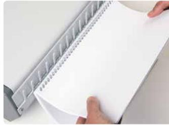
Das vorgestanzte Bindegut wird in das bereitstehende Bindeelement in der integrierten Haltevorrichtung eingehängt.
