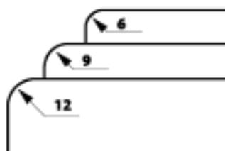
Der CYKLOS UCR 9 Eckenrunder wird mit 3 Werkzeugen geliefert. Es ist möglich zwischen 6mm, 9mm oder 12 mm Radien wechseln. Mit dem stabilen Hebel lässt sich dieser Eckenrunder leicht bedienen und die 45° Anlegewinkel gewährleisten eine optimale Verarbeitung von Stapelhöhen bis 5 mm.
