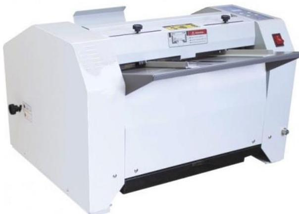
Kompaktes, zuverlässiges Heft-Falzgerät zur Broschüren Herstellung für Papierformate von A5 bis 320mm x 150mm, fertige Broschüren A6 bis A4. Einfach bis zu 15 Blatt Papier anlegen, die Maschine falzt und heftet in einem Durchgang und wirft die fertige Broschüre aus.
